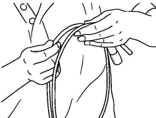
Wenn man ein Kabel nach guter alter "Väter Sitte" in einen Ring zusammen legt, wird dies immer "zwirbelfrei" abgerollt werden können. Dazu muss man es nur schon während des Zusammenrollens bei jedem vollen Umfang mit einer leichten Drehung in Richtung gerolltem Kabel versehen. Dann wird daraus auch ein Kabelring und kein Knäuel...
