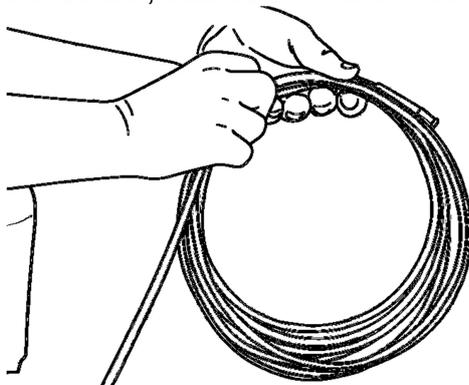
Versuche, das Kabel gleichmässig aufzuwickeln, sodass jede Schlaufe dieselbe Grösse hat. Dein Ziel ist es, das Kabel so aufzuwickeln, dass nichts absteht. Die Stecker am gewickelten Kabel sollten nicht zusammengesteckt werden, das kostet beim nächsten Aufbau nur wieder Zeit.
