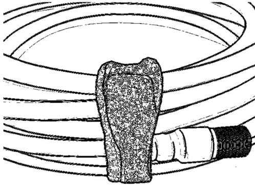
Hast du das Kabel aufgewickelt, wirst du es sichern müssen. Ein Kabel-Klettband lässt sich dafür hervorragend einsetzen. Ein Knoten oder eine Schlaufe mit den Steckern ist auf keinen Fall zugelassen.
