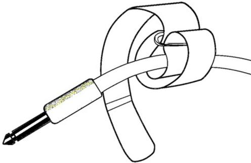
Es gibt eine Methode mit der das Kabel-Klettband, mittels Schlaufentechnik, dauerhaft, auch im geöffneten Zustand, am Kabel befestigt werden kann. Dazu braucht man Kabel-Klettband mit Klett und Flausch auf unterschiedlichen Seiten und geht wie links gezeigt vor.
